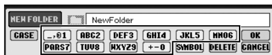
Каждой кнопке присвоено нескольких символов, которые сменяют друг друга при каждом следующем нажатии.
