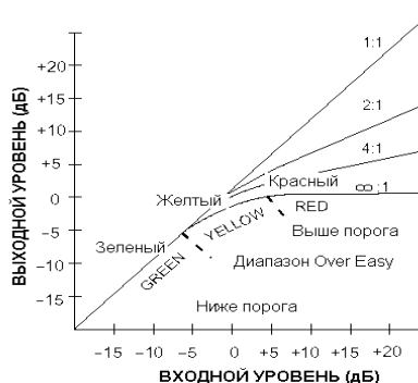
Рисунок 2: Кривая компрессии с перегибом OverEasy и светодиодные индикаторы THRESHOLD
