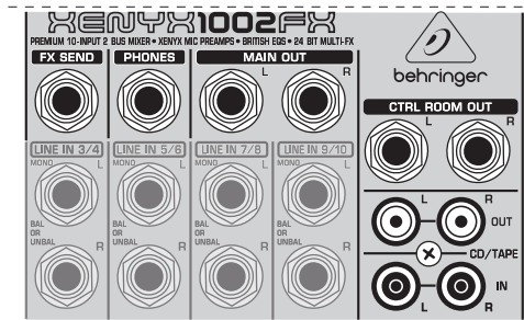
Рис.2.3: Разъёмы главной секции
