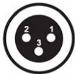
DMX – выход панельный разъем XLR «мама»
