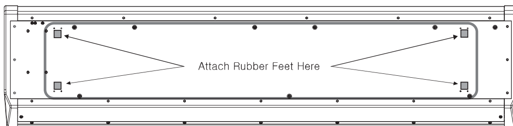
Рисунок 2 – 1 Размещение резиновых ножек
