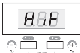
Рисунок 4 – 17 Настройка самой верхней ноты зоны
