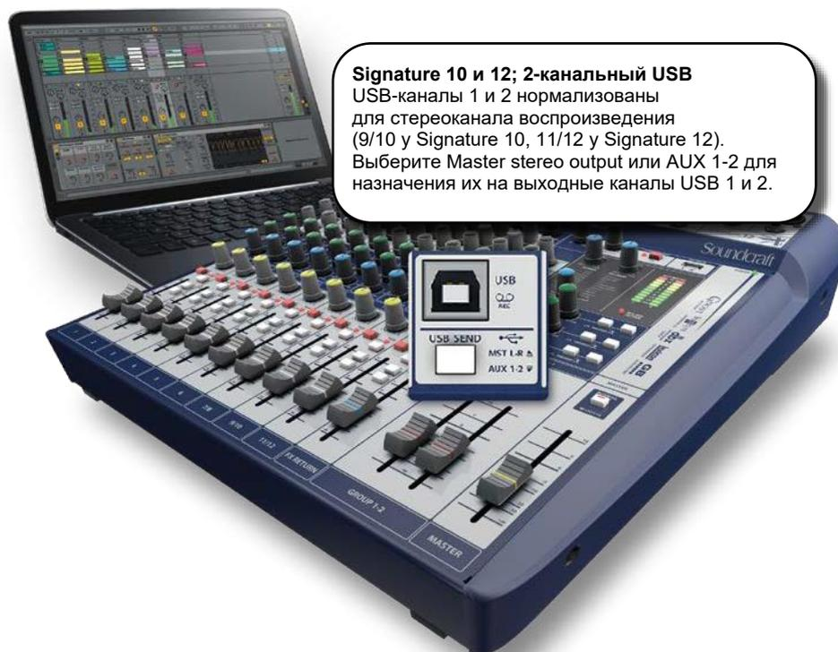
Консоли Signature 10 и 12 поддерживают функцию 2-дорожечного ввода и вывода через порт USB. Ее можно использовать для записи микса на компьютер или планшет либо для использования компьютера как устройства воспроизведения. Каналы 1 и 2 принимаются стереоканалом с максимальным номером (9/10 у Signature 10, 11/12 у Signature 12).
