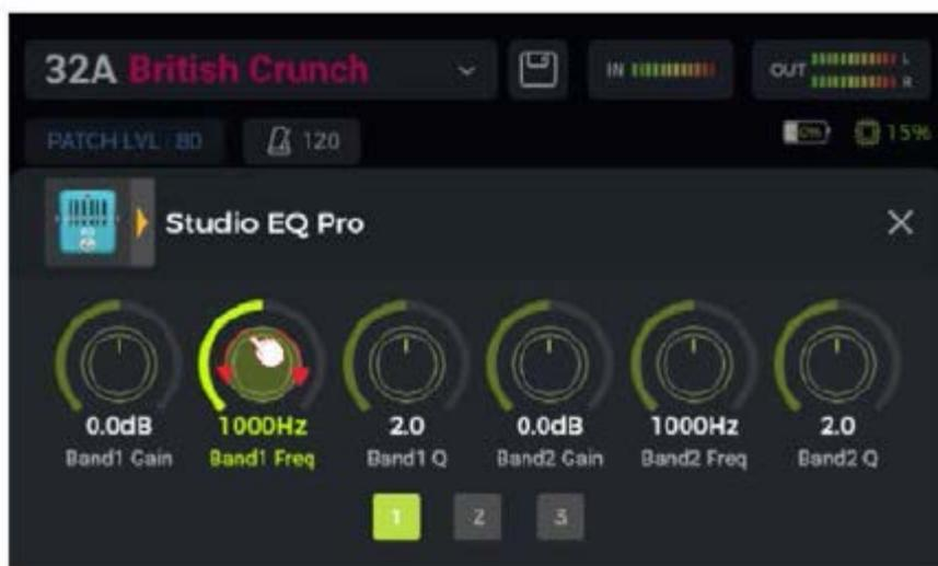
**Вариант 2:** Коснитесь ручки нужного параметра на сенсорном экране (название параметра будет выделено зеленым цветом) и с помощью ручки SELECT точно установите нужное значение. Для возвращения параметру настройки по умолчанию нажмите на ручку SELECT.
