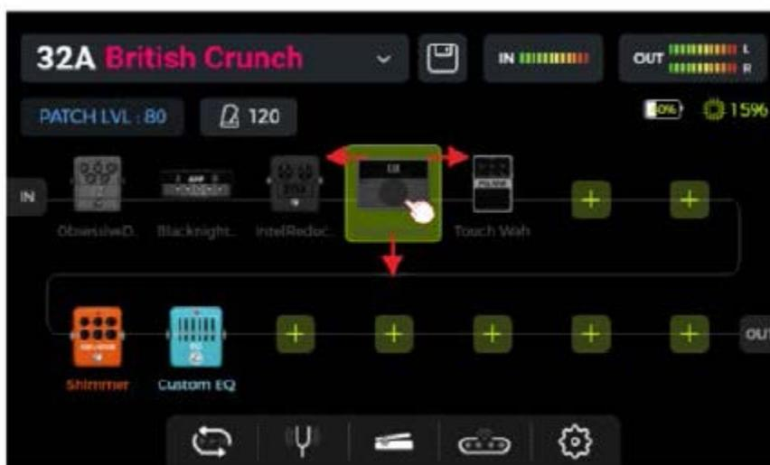
**Вариант 2:** Выберите модуль на сенсорном экране (будет выделен рамкой) и поворачивайте ручку SELECT для его перемещения.
