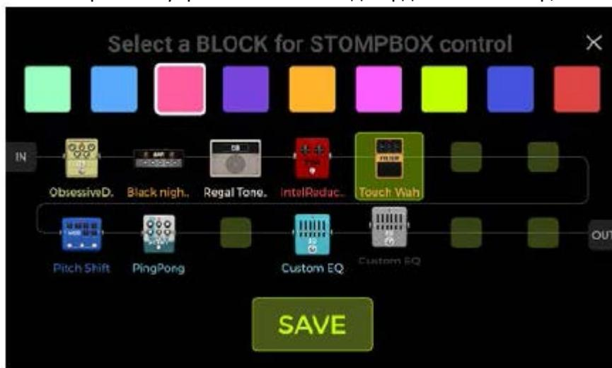
Если выбрана функция STOMPBOX (MULTIPLE), будут отображаться все модули эффектов в текущей цепочке эффектов. Можно выбрать несколько из модулей, нажимая на них. Затем эти модули будут напрямую и одновременно включаться/выключаться в режиме управления CTRL. Подтвердите свой выбор, нажав кнопку SAVE.
