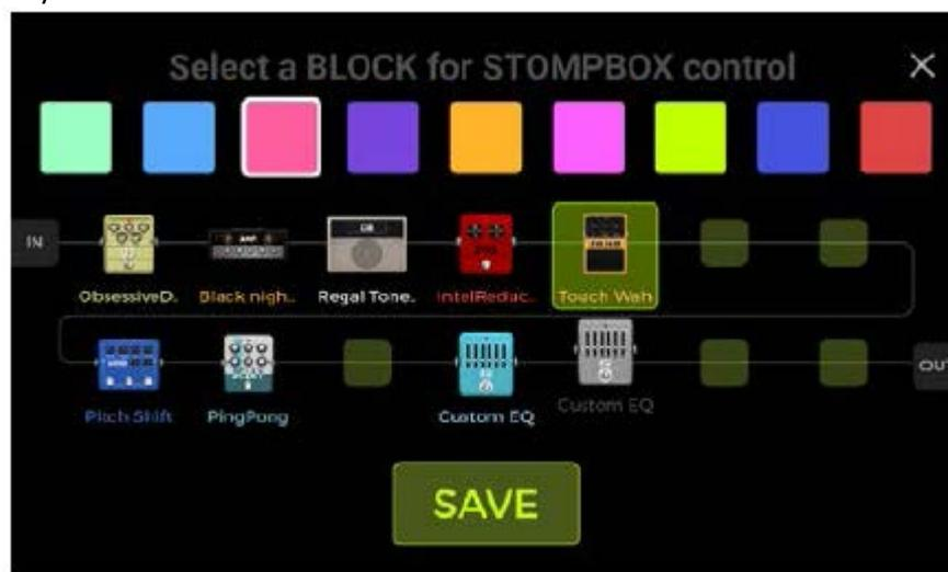
В верхнем ряду каждого экрана выбора можно выбрать цвет для поля соответствующего ножного переключателя на экране CTRL, что облегчит поиск правильного эффекта на сцене (тот же цвет будет использоваться и для светодиодного кольца вокруг ножного переключателя).
