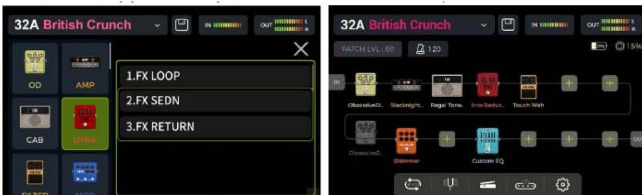
Добавьте в цепочку эффектов один модуль эффектов «FX LOOP» с типом «FX SEND» и еще один с типом «FX RETURN». Эта настройка подходит для тех случаев, когда внешние эффекты располагаются параллельно некоторым внутренним эффектам или для переключения А/В. Фактическая цепь передачи сигналов показана на рисунке ниже:
