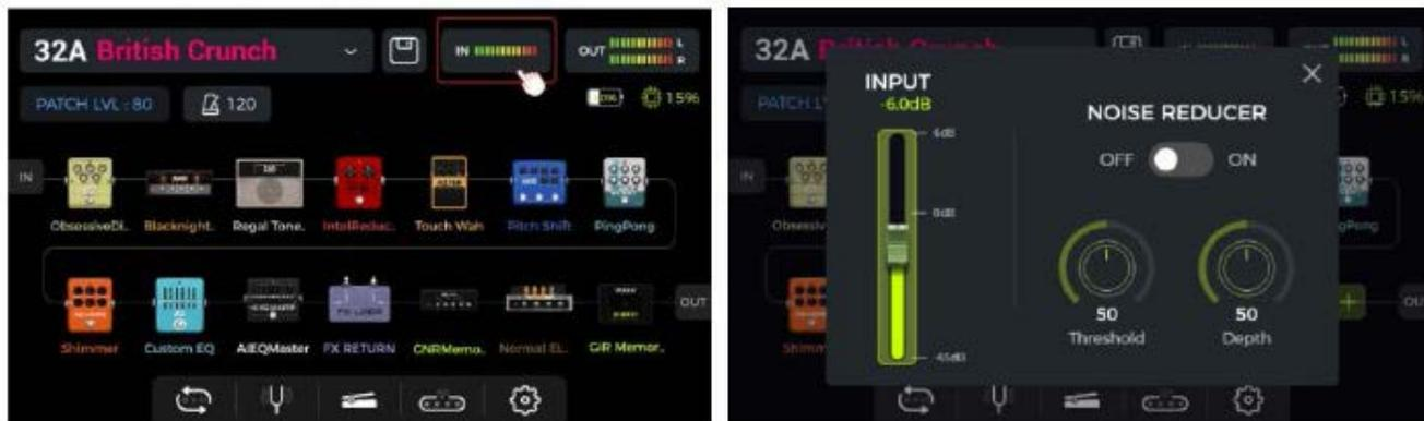
В левой части всплывающего окна можно настроить входное усиление. Используйте его для компенсации сильных сигналов от звукоснимателей инструментов с разными выходными характеристиками или от педалей усиления сигнала (буст, овердрайв, дисторшн...) перед процессором GE1000.
