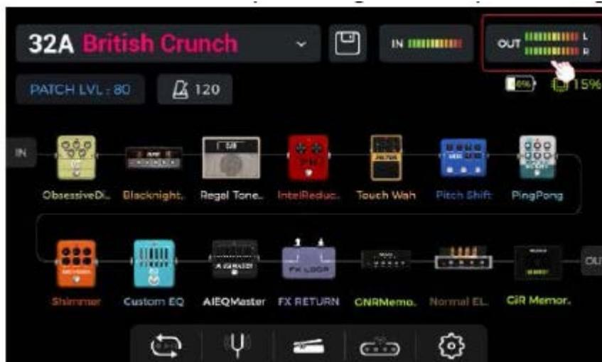
Для получения визуального подтверждения уровня выходного сигнала в конце цепочки эффектов, смотрите на индикацию уровня выходного сигнала на экране или наблюдайте за светодиодным индикатором выходного уровня в конце ряда физических кнопок модулей эффектов. Зелёный цвет индикации означает, что все нормально, красная индикация означает, что выходной сигнал ограничивается, т.е. искажается.
