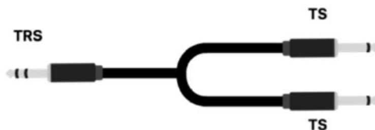
(кабель-разветвитель со штекером TRS на одной стороне и двумя штекерами TS на другой)
