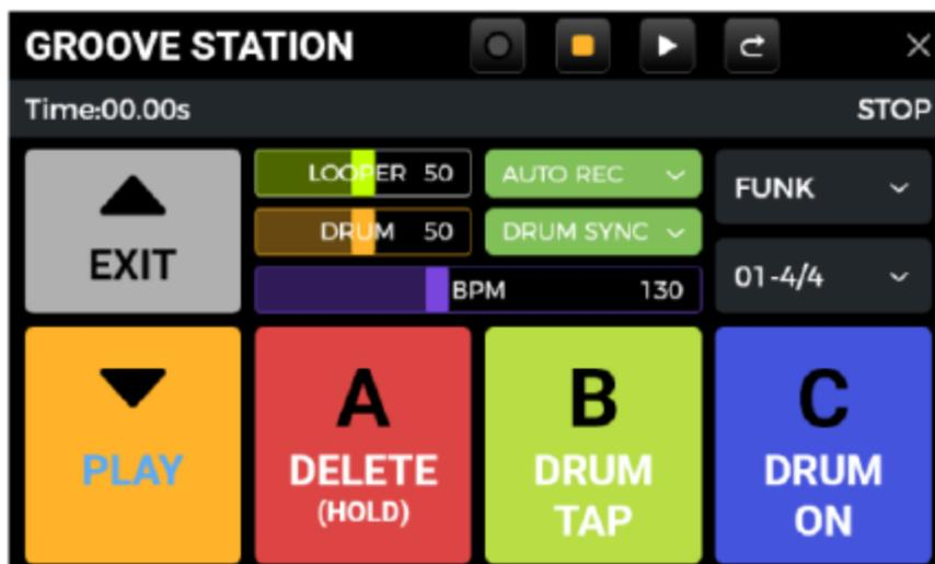
Пять больших квадратных значков на экране Groove Station обозначают функции ножного переключателя, которые будут выполняться при его следующем нажатии. Для выполнения функций можно нажимать на квадраты на сенсорном экране или нажимать соответствующие ножные переключатели.
