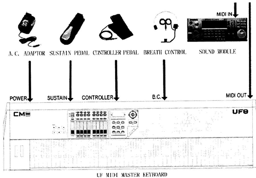
1.3.1 Соедините разъем MIDI OUT клавиатуры с разъемом MIDI IN звукового модуля посредством MIDI кабеля.
