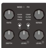
Либо в PRESET MODE, либо в EDIT MODE вы можете настроить ручки RATE, EDPTH, LEVEL<sup>®</sup> для настройки параметров блока MOD; Вы можете настроить ручки SENSE, LEVEL<sup>®</sup>, чтобы настроить параметры блока FX.
