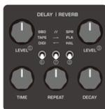
Либо в PRESET MODE, либо в EDIT MODE вы можете настроить ручки LEVEL<sup>5</sup>, TIME, REPEAT для настройки параметров блока DLY; вы можете настроить ручки LEVEL<sup>9</sup>, DECAY для настройки параметров блока RVB.
