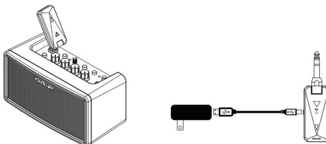
Вы также можете заряжать трансмиттер через USB, но использование и зарядка устройства одновременно невозможны.
