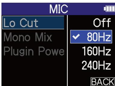
Частоту среза можно установить на OFF, 80 Гц, 160 Гц или 240 Гц.
