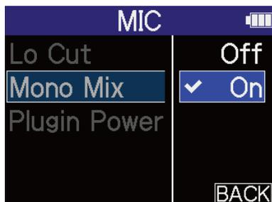
Когда выбрано «On», встроенный вход для микрофона XY станет монофоническим.
