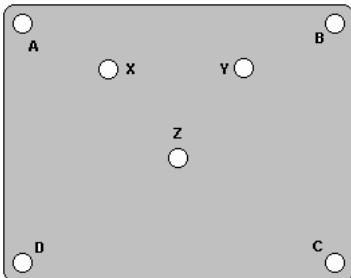
1. Открутив винты «A, B, C, D» снимите ламповый блок для замены / установки лампы.
