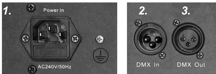
1. **Power In:** IEC разъем с держателем предохранителя для подключения кабеля питания.
