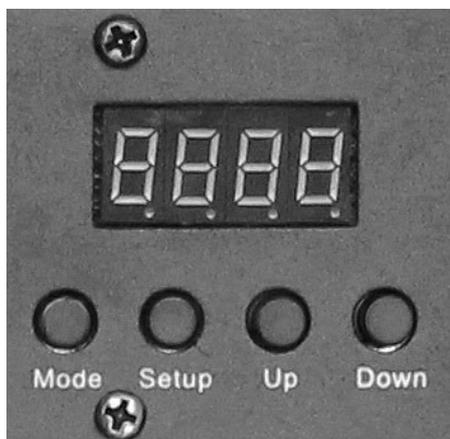
Устройство может работать в автоматическом режиме, режиме звуковой активации или в режиме управления по протоколу DMX. Режим работы и его настройки осуществляются с помощью кнопок меню. Для управления устройством в режиме DMX используется 3 канала. Вы можете управлять OB200 с помощью любого стандартного DMX контроллера.
