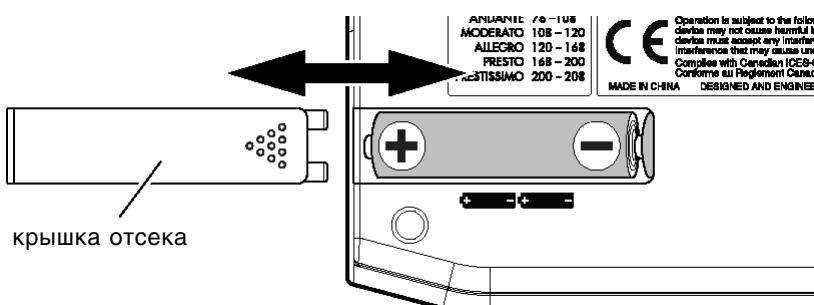
3. Закройте крышку батарейного отсека.
