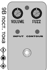
**Важное замечание!** Неправильное подключение полярности проводов питания вызовет неисправность данного блока питания, поэтому, перед его использованием убедитесь в правильности подключения положительного и отрицательного проводов питания.
