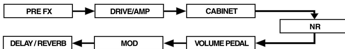
Блок VOLUME PEDAL доступен только при подключении педали к разъему PEDAL.
