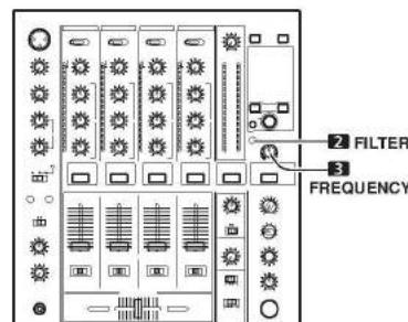
Фильтр частоты эффекта связан с регулятором **FREQUENCY**. Ритм-эффект применяется только к выбранной полосе частот.
