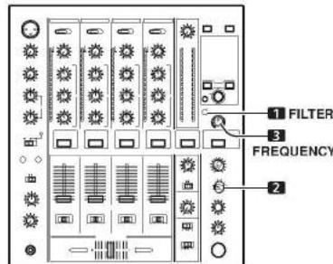
Ручной эффектор связан с регулятором **FREQUENCY**. Выходные аудиосигналы с ручного эффектора становятся входными сигналами для ритм-эффектов.
