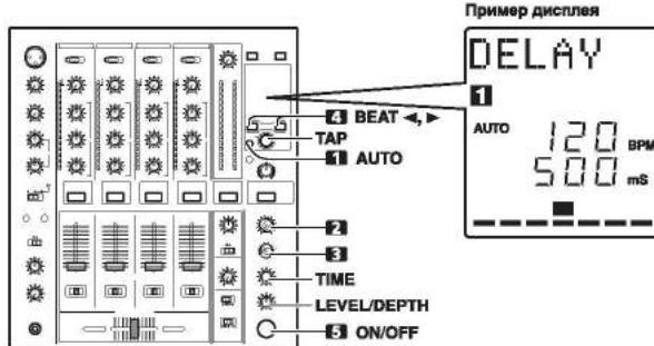
Ритм-эффекты позволяют производить очень быструю установку времени эффекта, синхронного с BPM (ударов в минуту) и, тем самым, обеспечивают получение широкого разнообразия эффектов, синхронных с текущим ритмом, даже во время живых представлений.
