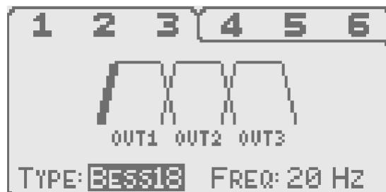
Каждый пропускной фильтр, связанный с кроссовером, представлен на экране в графическом виде. Наклонные участки графика представляют граничные частоты, в то время как плоская часть показывает выбранный уровень полосы пропускания фильтра. Точки пересечения наклонных участков соответствуют точкам пересечения частотных диапазонов кроссовера.
