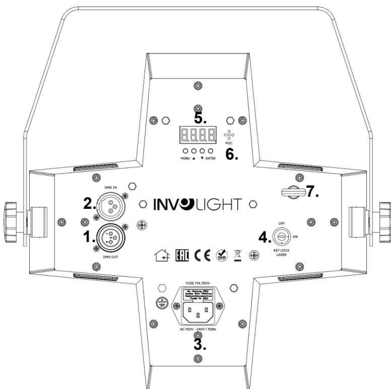
1. **DMX Out:** 3-контактный разъем XLR-«выход» для передачи DMX-сигнала.
