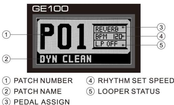
Установите переключатель режимов в положение [PL], на ЖК-дисплее отобразится информация о номере текущего патча. GE100 имеет 80 предустановленных патчей и 80 пользовательских патчей. Нажмите педальный переключатель [PATCH ▼] или [PATCH ▲], чтобы изменить патчи. (Держите один футсвитч для быстрого переключения патчей).
